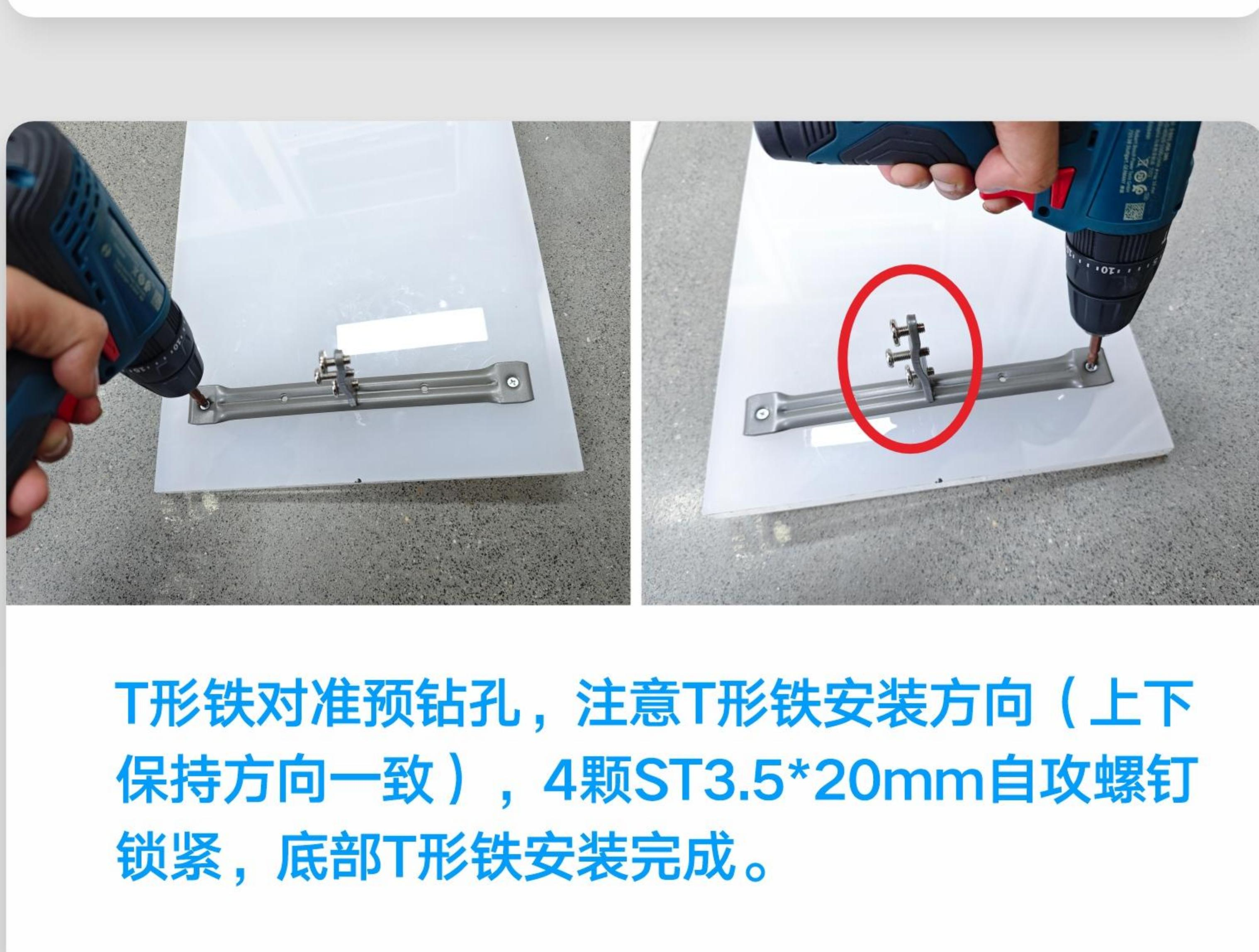
T形铁对准预钻孔，注意T形铁安装方向（上下保持方向一致），4颗ST3.5\*20mm自攻螺钉锁紧，底部T形铁安装完成。
