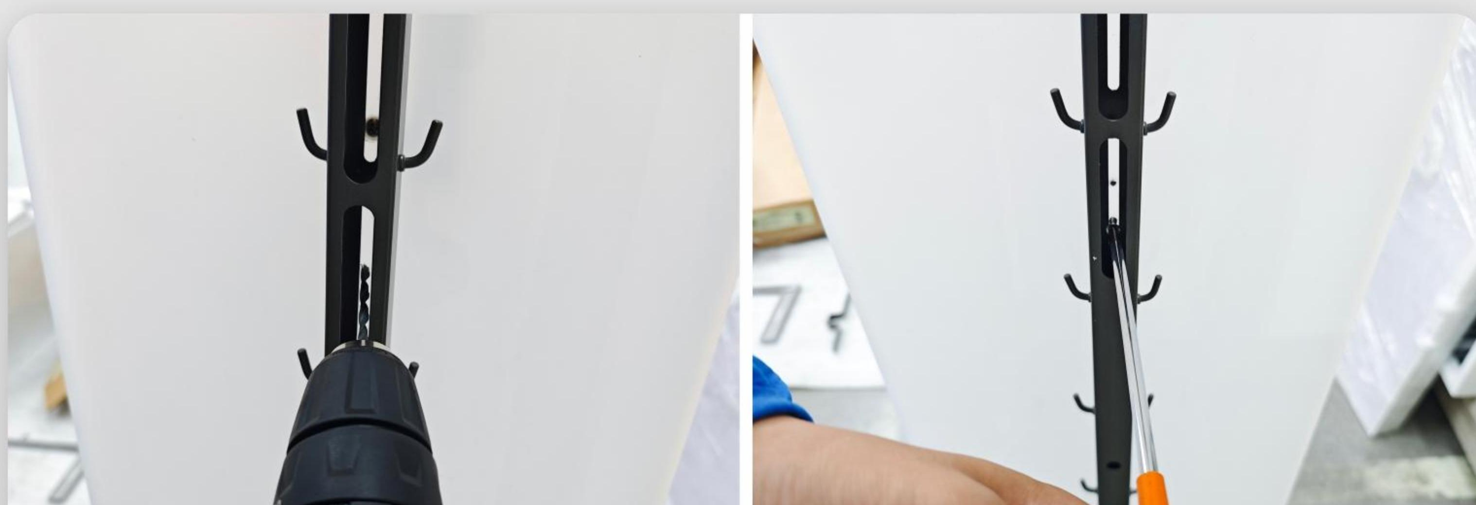
在门框中间椭圆孔位置，使用1颗ST4.0\*16mm自攻螺钉锁紧门板，门板与主框架固定完成。
