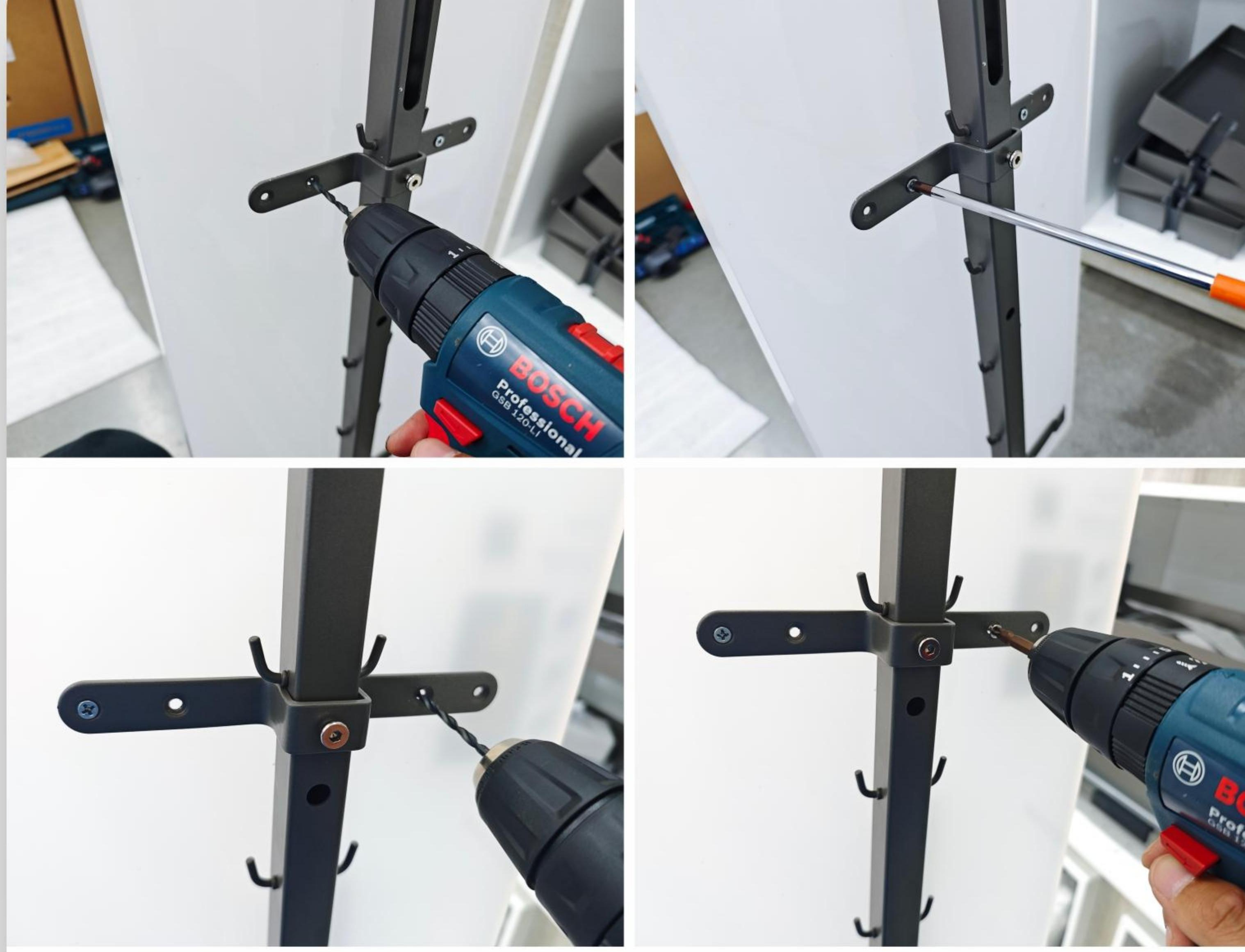
门板调整完成后，按照实际柜体高度，安装两个固定桥形铁（建议按等分门板距离），预钻孔后使用各4颗ST4.0\*16mm自攻螺钉锁紧桥形铁。
