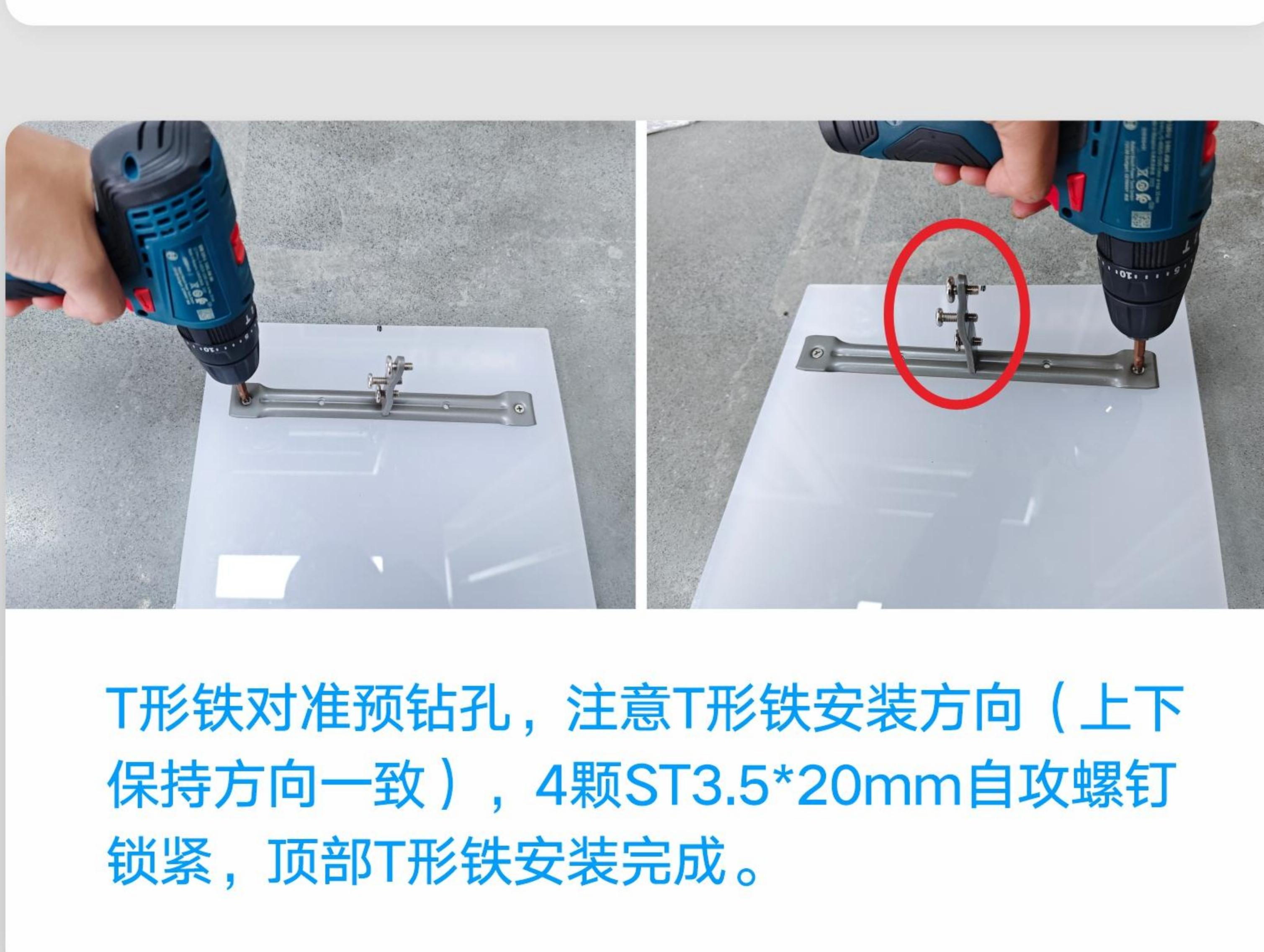
T形铁对准预钻孔，注意T形铁安装方向（上下保持方向一致），4颗ST3.5\*20mm自攻螺钉锁紧，顶部T形铁安装完成。
