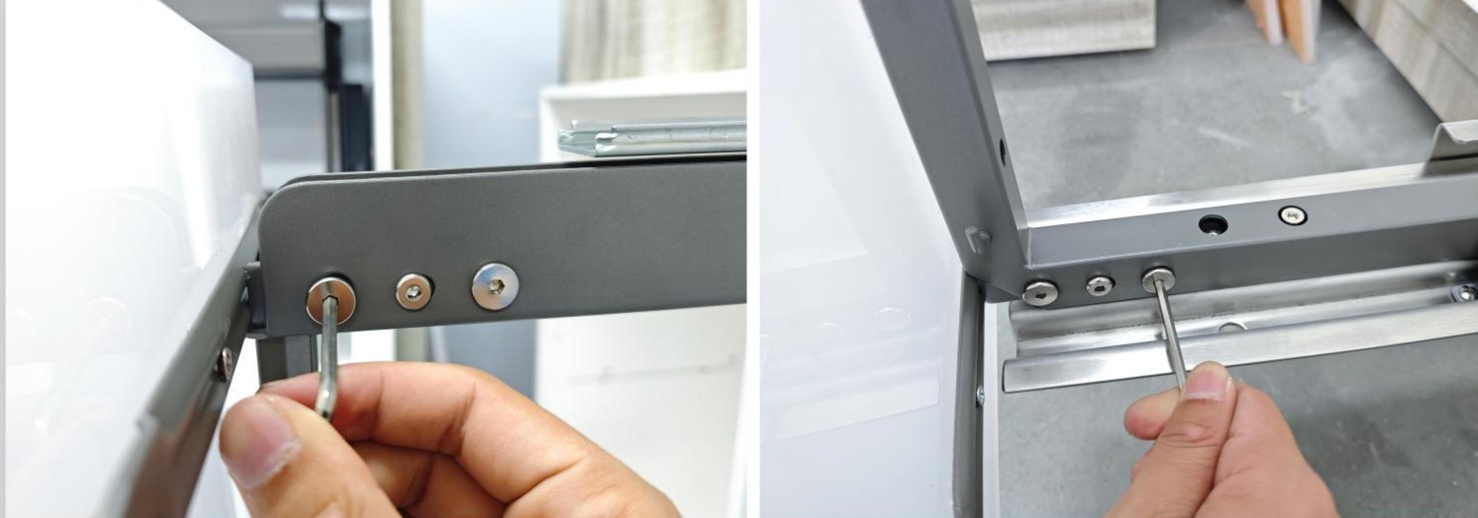
将T形铁对准主框架插入，再将拆除的螺钉按预装位置拧入固定。
