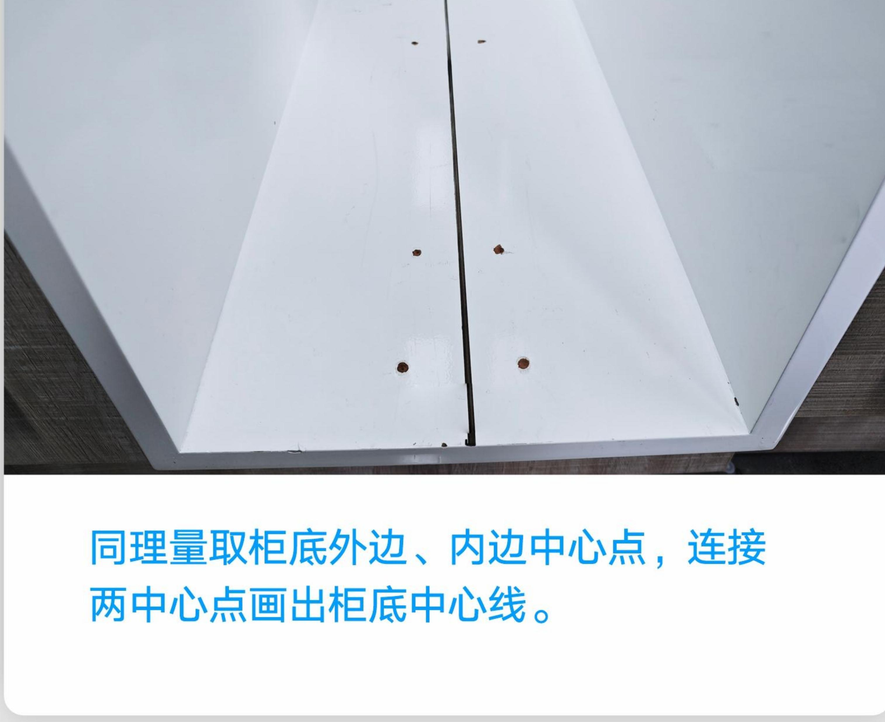
同理量取柜底外边、内边中心点，连接两中心点画出柜底中心线。
