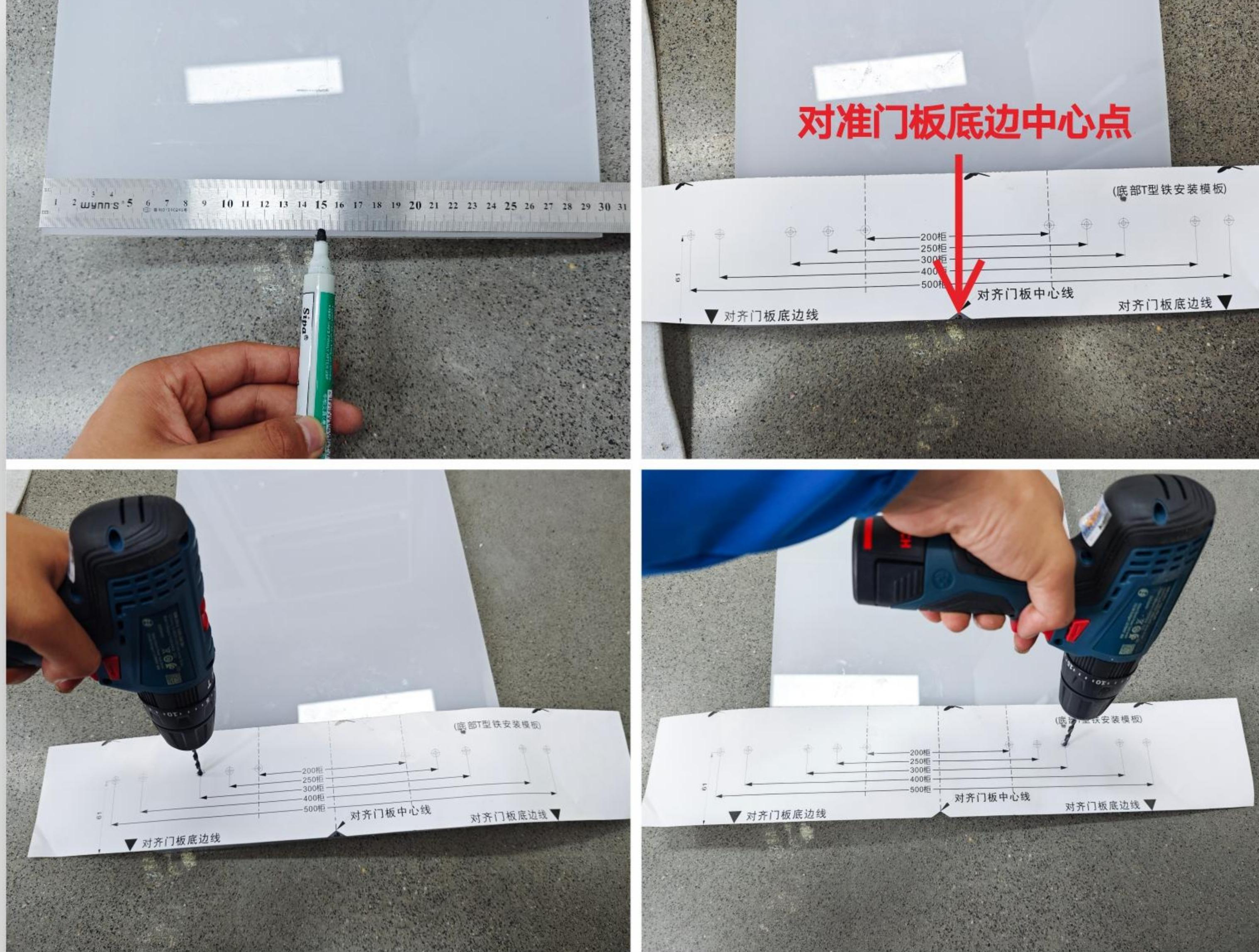
同理量取柜门底边中心点，使用底部T型铁安装模版对准中心点，预钻孔。
